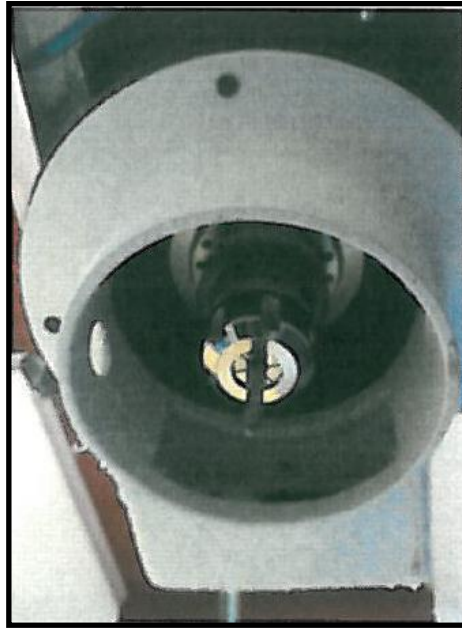
شكل رقم (٢٦) جهاز الحفر مع وحدة الشفط
