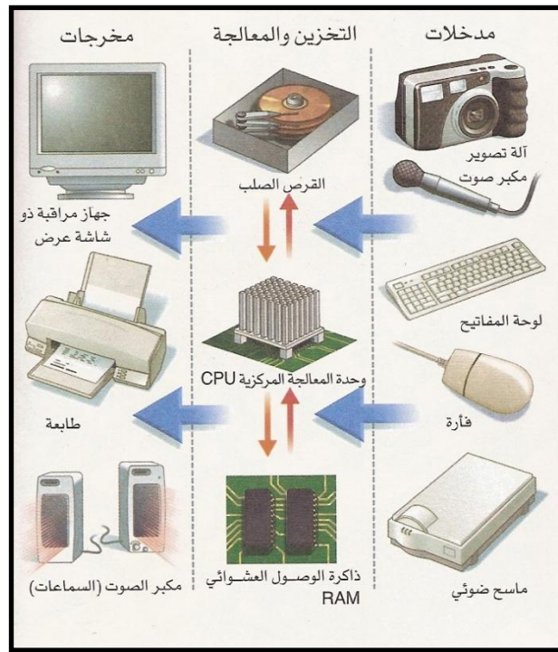
صورة (١٠) توضيح المكونات الأساسية للحاسب الآلي
